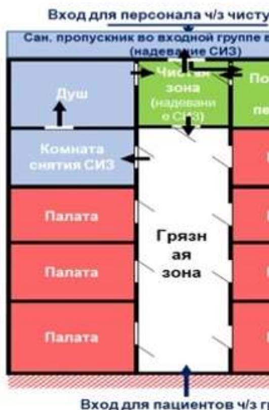
Схема модульного инфекционного стационара
